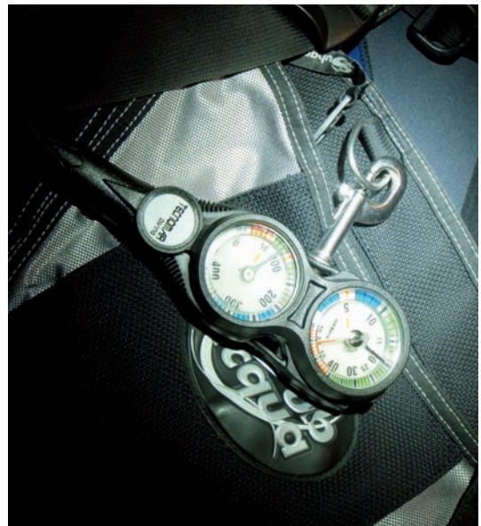
Manómetro trincado con mosquetón.
