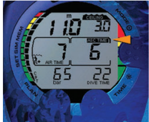
Figura 3.16 Los ordenadores que calculan la descompresión de forma continua indican como en este caso, la profundidad límite (ceiling 3 m) y el tiempo total de ascenso (ASC TIME 6 min)
