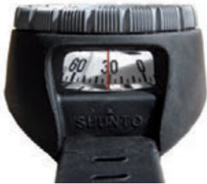
Figura 1.12 Ventana en la que se lee el rumbo que señala la línea de fe: 30°
